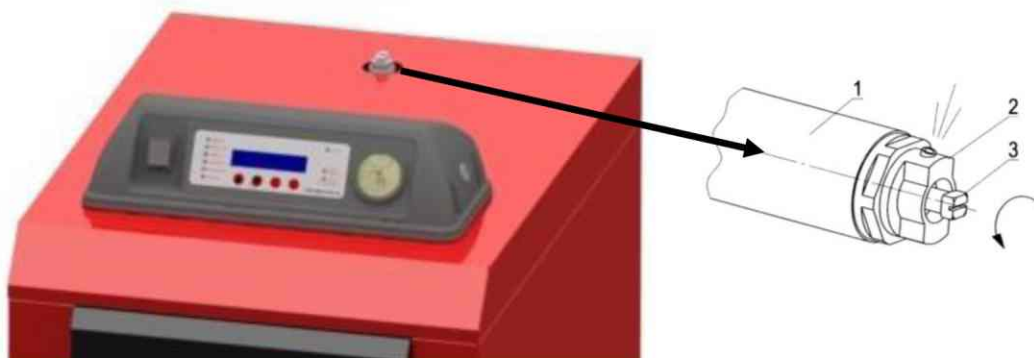
Nákres.10. Odvzdušňovač: 1 – trubka odvzdušnění, 2 - odvzdušňovač, 3 - šroub.
